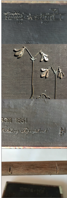
J.C. Drewsen formen – detaljer: Fra oven: filigran med skitse af papirmaskine, filigran af Linnea-blomster og filigran med årstal, Silkeborg Papirfabrik og monogram. Nederst – dækket med forbedring og reparation.
